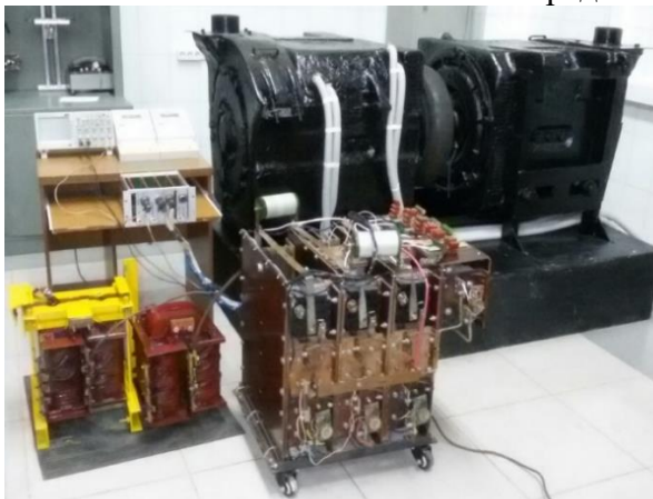
Рисунок 12 – Научно-экспериментальный стенд в «Мини – депо» ИрГУПС, для исследования работы предлагаемых ВИП и ВУВ электропоезда
